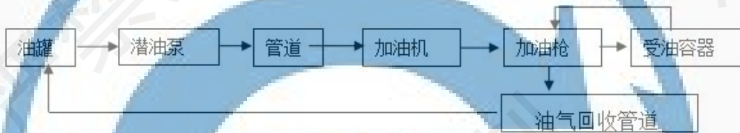
柴油加油工艺流程框图
